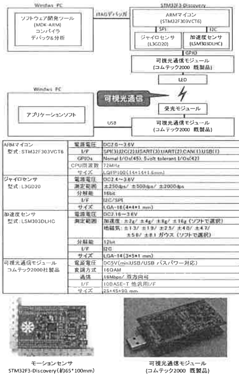
図8 モーションセンサ動作確認実験概要
