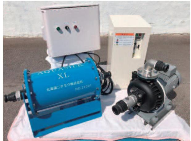
図 2 酸素ナノ・マイクロバブル発生装置 AQUASILK（北海道ニチモウ株式会社製）
